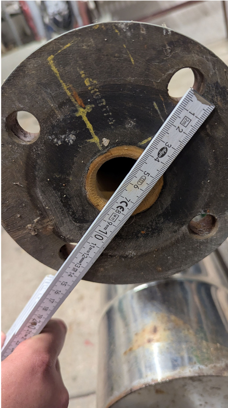
Abbildung 10: Lochkreis Anschluss Filtergehäuse
